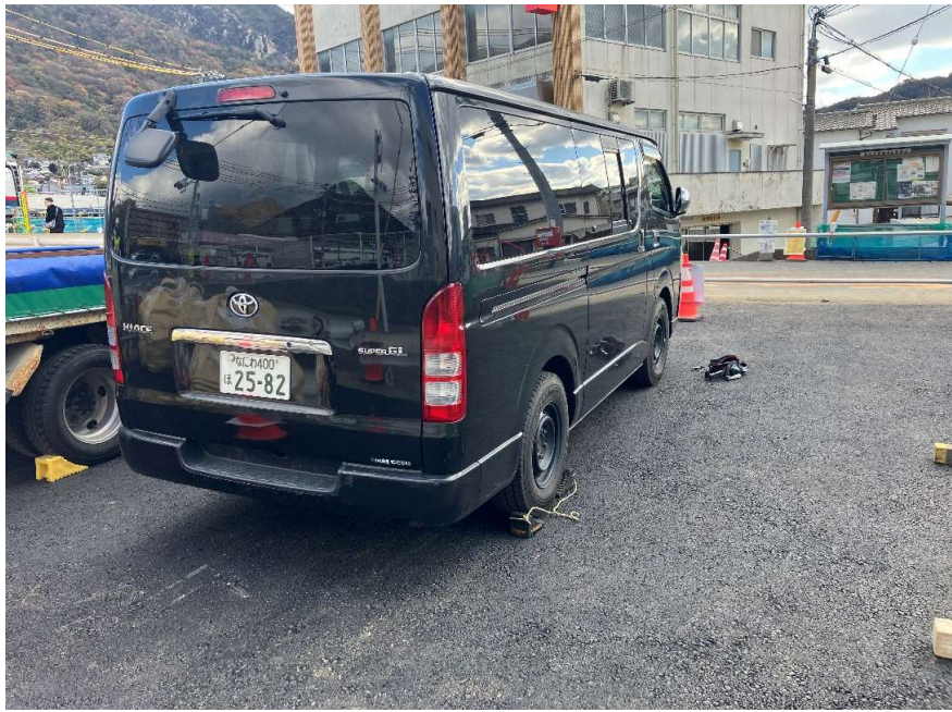
工事関係車両車輪止め設置状況①
